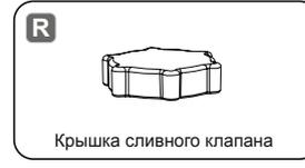
Крышка сливного клапана
